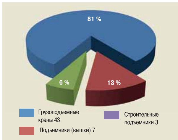
Рис. 39. Распределение аварий по видам подъемных сооружений
