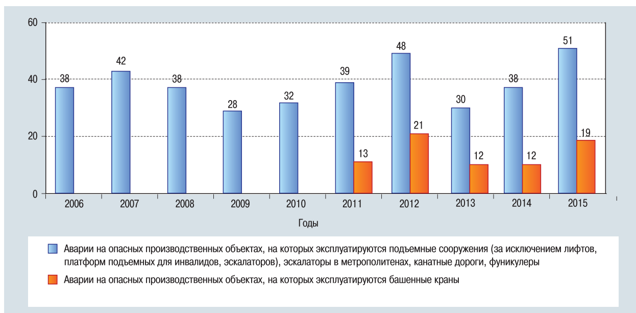
Рис. 48. Динамика аварийности при эксплуатации стационарно установленных грузоподъемных механизмов за 2006 — 2015 гг. с приведением количества аварий с башенными кранами за последние пять лет
