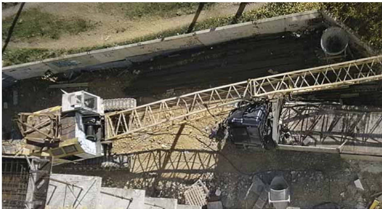
Рис. 55. Падение стрелы грузоподъемного гусеничного крана МКГ-25 БР в результате обрыва стрелового каната в г. Евпатория
